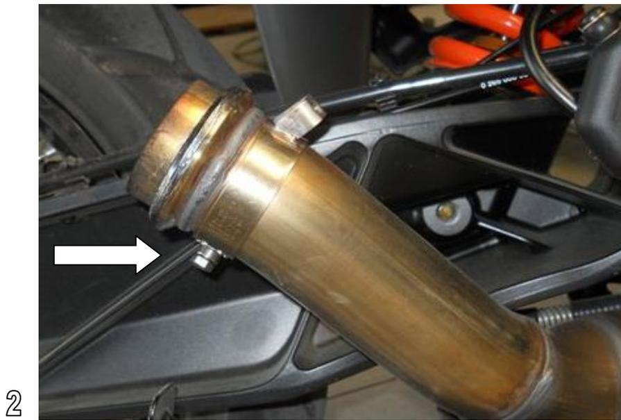
2. Verbinden Sie den REMUS Endschalldämpfer mit dem Serien-Verbindungsrohr und ziehen Sie die Schrauben Halter und an der Schelle leicht an. (Abb. 3 / Abb. 4) **VORSICHT:** Verwenden Sie die serienmäßige Dichtung
